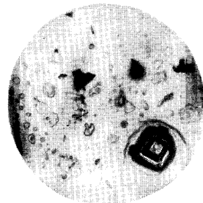
Рис. 90. Фигуры травления на плоскости (100) кристаллов ИАГ (ув. 160)
