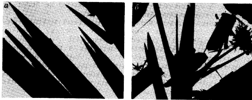
Рис. 56. Морфология кристаллов изоморфно замещенных муллитов: а — мономинеральный тонконгольчатый муллит, ув. 4000; б — паразитные сферолиты на иглах муллита, ув. 8000
